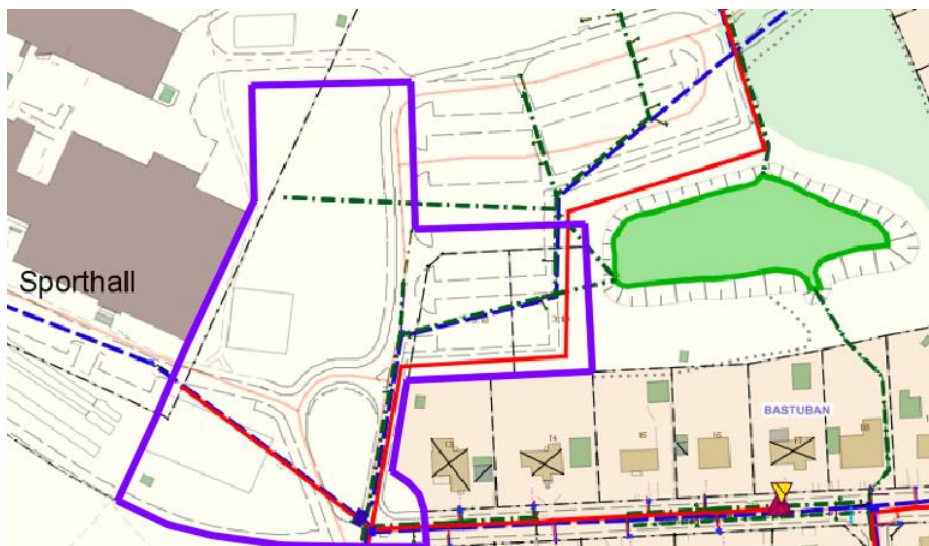
Figur 29: Kartan visar dagvattendammen öster om planområdet (den mörkgröna ytan i kartan) samt befintliga dagvattenledningar (med grönt streckade linjer) på fastighet Norrby 3:1 inom och utanför detaljplanensgränsen (markerad med lilafärgad kontur).
